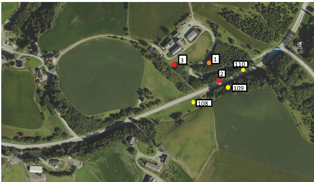
Figur 4 – Rød: Borpunkter, Rambøll, med påvist kvikkleire. Oransje: Borpunkt, Rambøll, med antatt kvikkleire. Gul: Borpunkter, Asplan Viak, med antatt kvikkleire.
