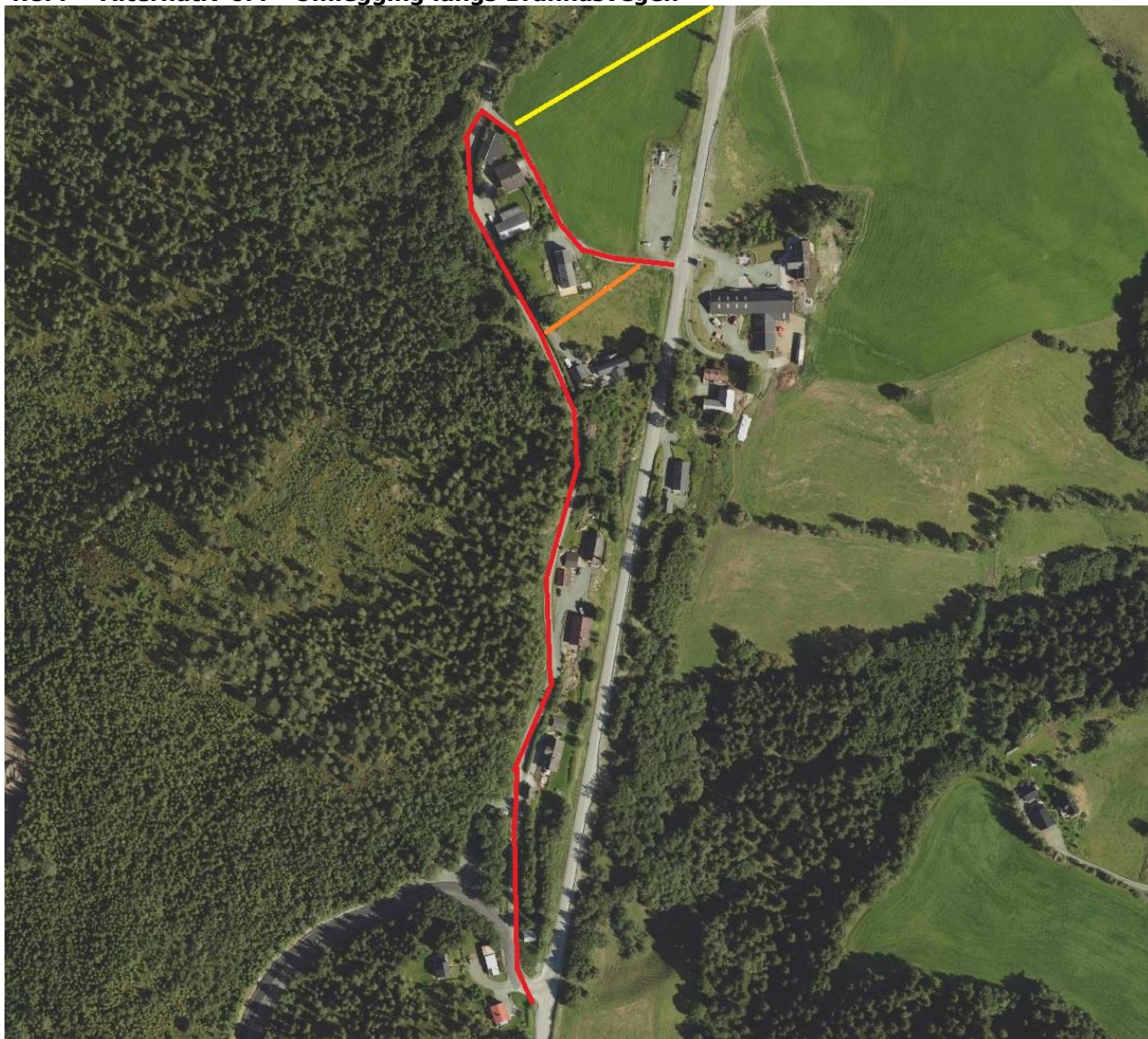
Figur 26 – Alternativ 6.4 – vurdert omlegging langs rød linje. Oransje og gul også sjekket mht. stigningsforhold.
